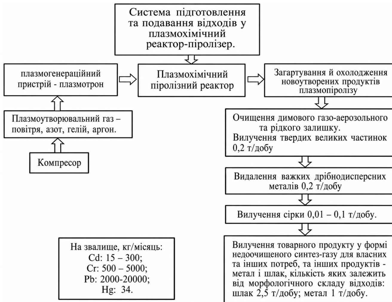
Рис. 1.1. Блок-схема плазмової дугової піролізної установки «Плазмон-3» продуктивністю [48].
