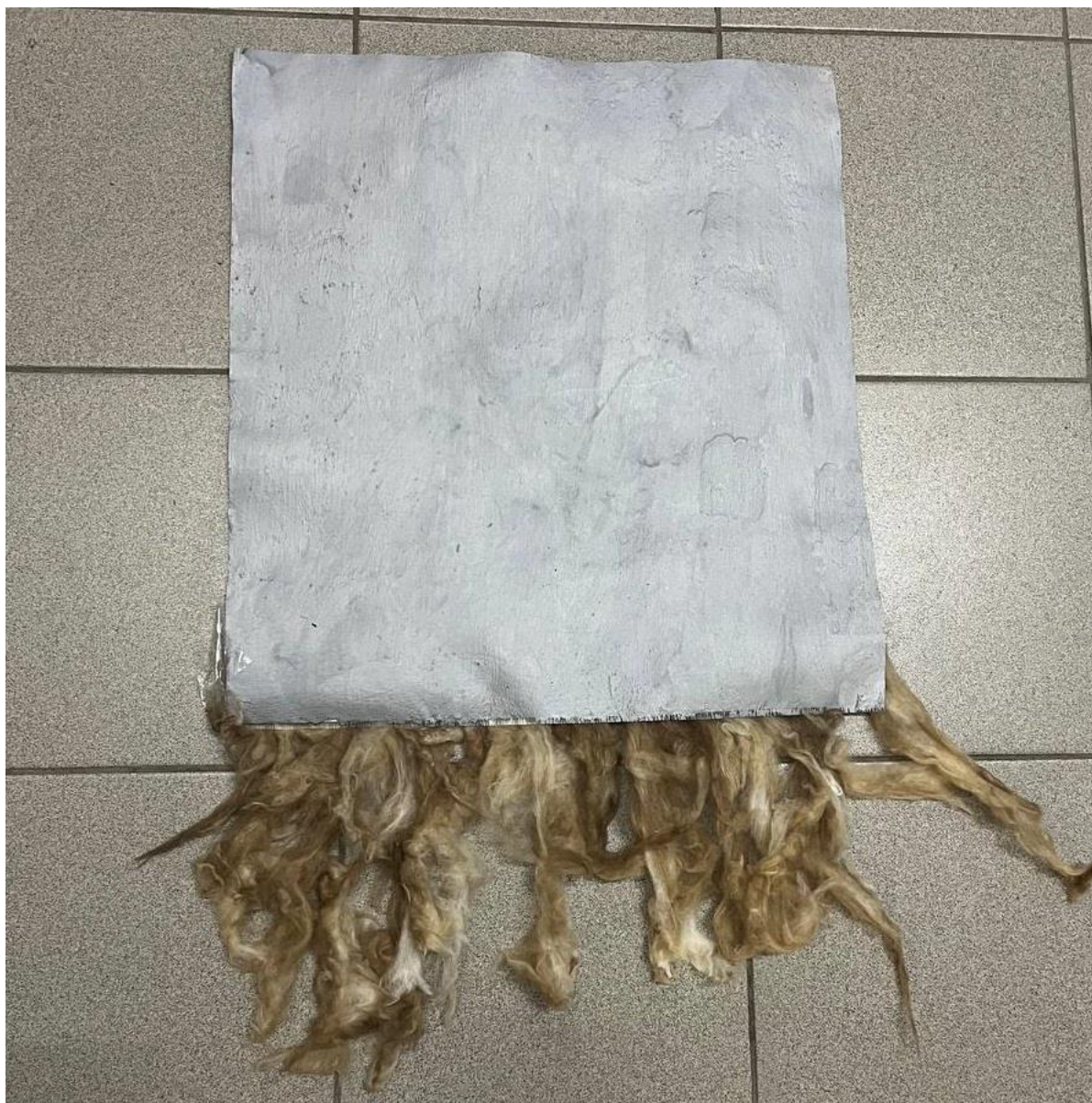
Рис. 3.14. Зображення макетного зразка із базальтовим розмиттям інфрачервоної сигнатури
