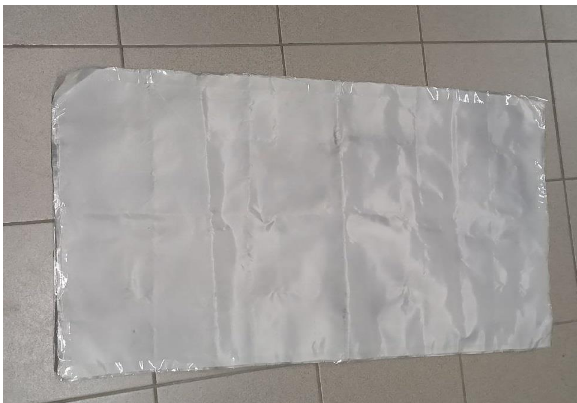
Рис. 3.20. Радіопрозорий матеріал для блокування інфрачервоного випромінювання антен радіозв'язку
