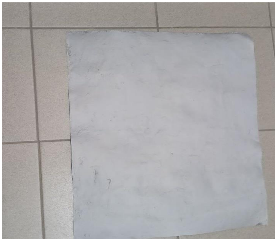
Рис. 3.21. Матеріал для одночасного блокування інфрачервоного випромінювання та випромінювання радіочастот
