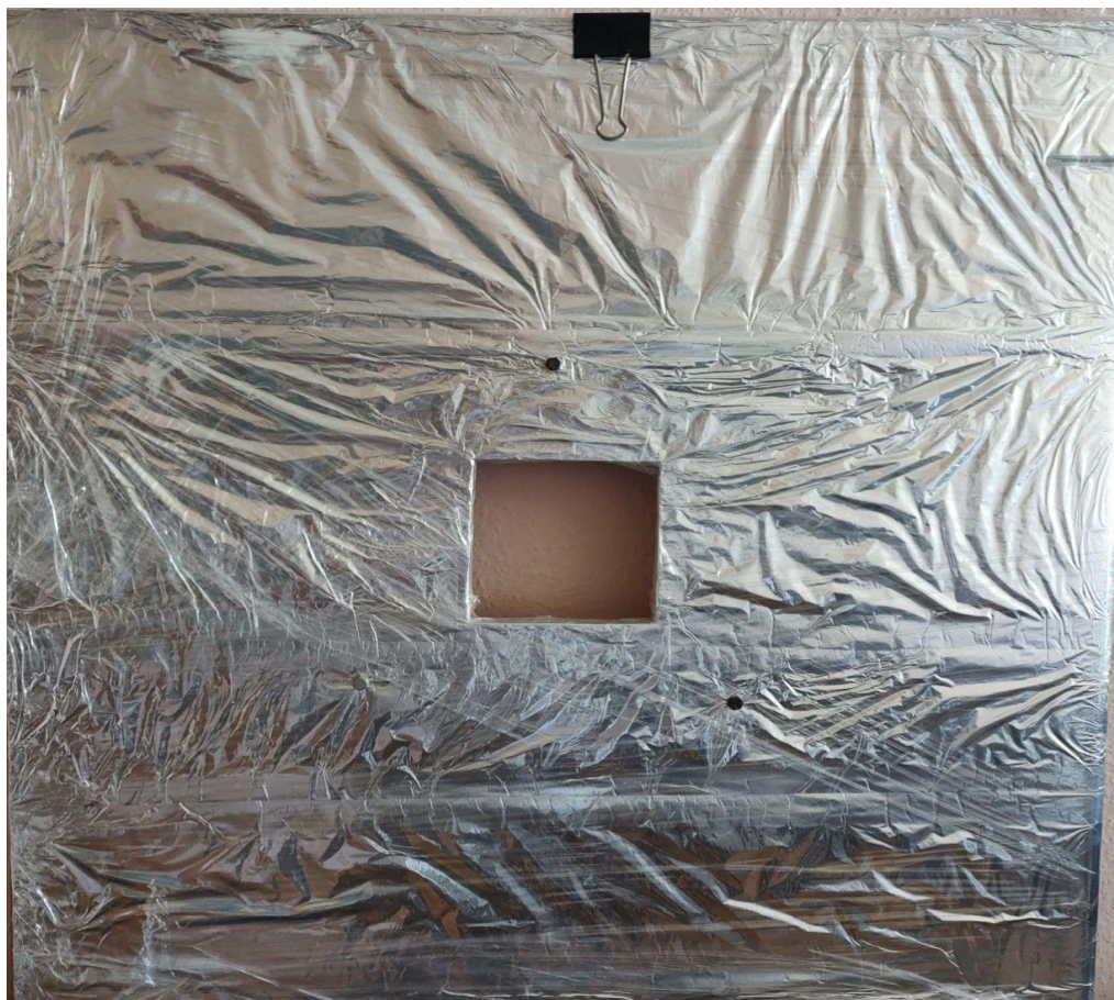
Рис. 2.2. Фольгований стенд для вимірювання змін коефіцієнта відбиття електромагнітних хвиль
