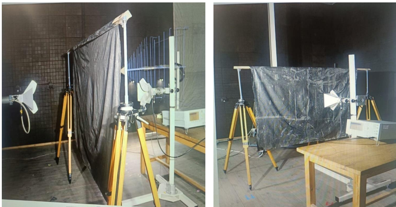
Рис. 2.3. Загальна схема установки для досліджень ефективності зразків в умовах, наближених до реальних
