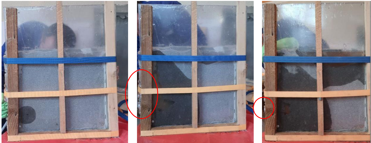
Рис. 3.29. Процес ін'єктування зразка із повнотілої цегли з попереднім заповненням тріщини кварцовим піском
