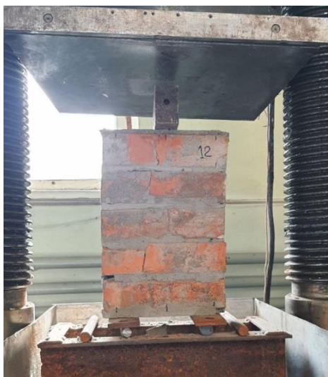
Рис. 3.32. Процес створення тріщин у зразках
