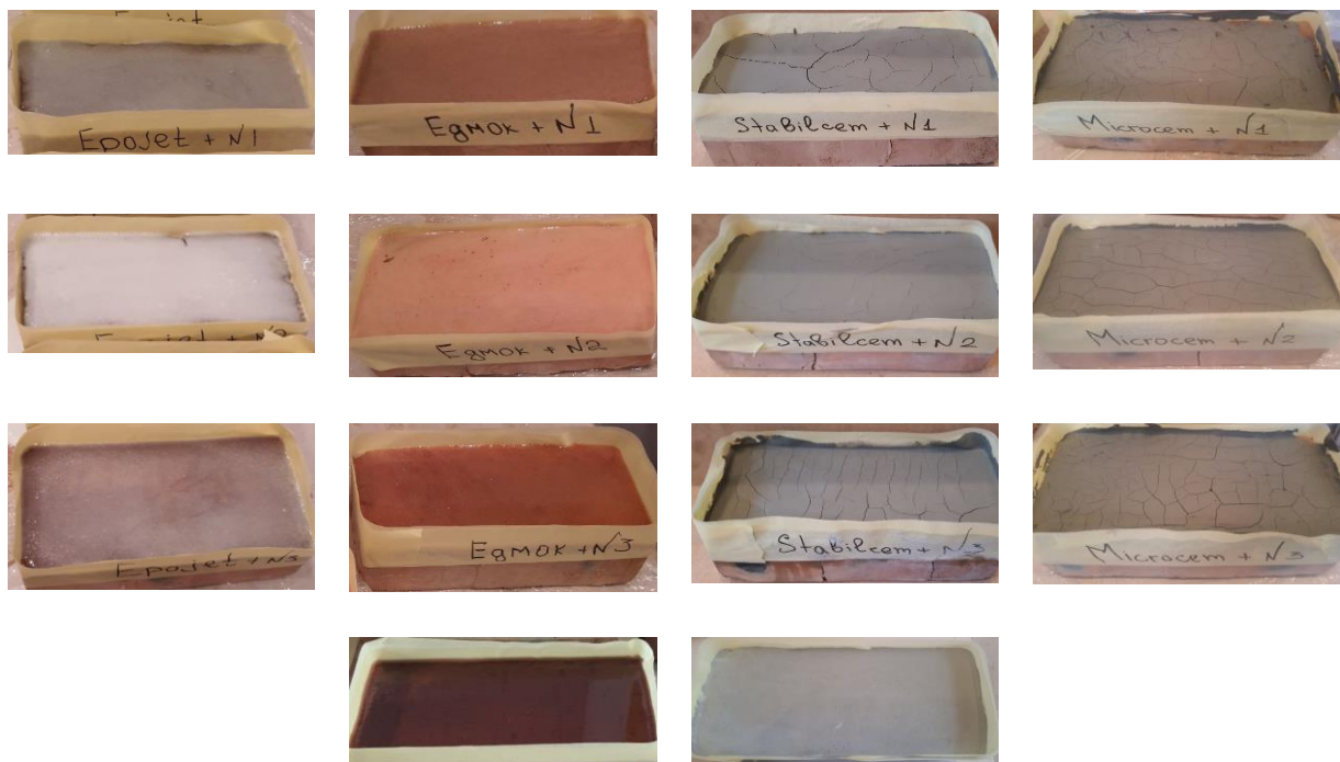
Рис. 3.15. Загальний вигляд партії зразків із цегли з ремонтними матеріалами з додаванням наповнювачів
