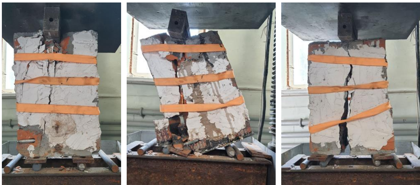
Рис. 3.35. Загальний вигляд зразків після прикладання повторного руйнівного зусилля (типові руйнування)
