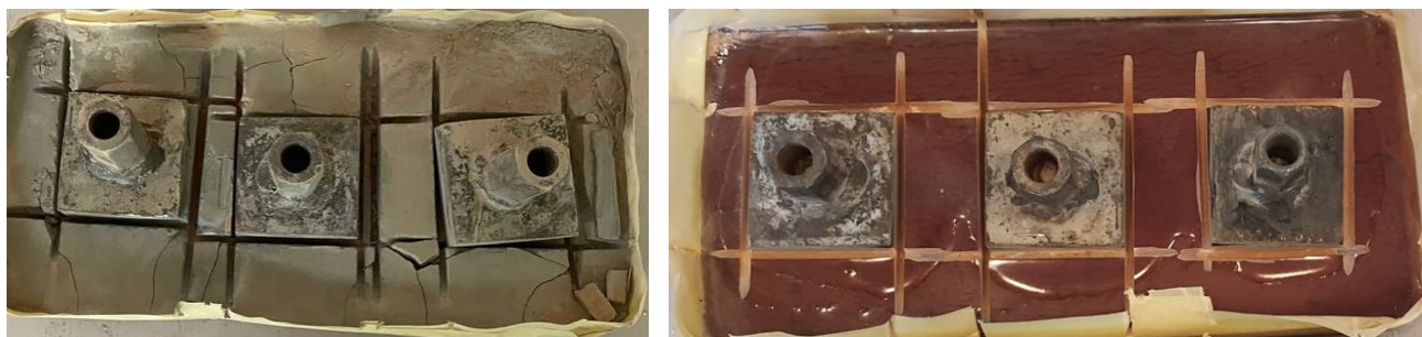
Рисунок 3.6. Підготовка зразків до проведення дослідження з визначення міцності зчеплення з основою
