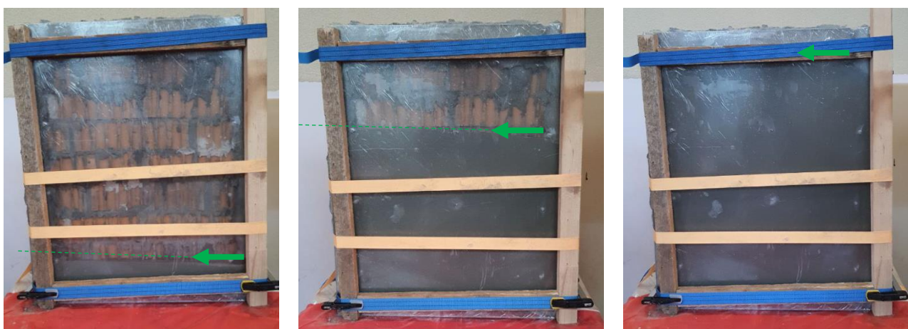
Рис. 3.26. Процес ін'єктування суміші в зразок із порожнистої цегли
