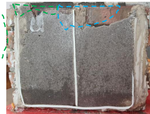
Рис. 3.30. Загальний вигляд зразка після полімеризації ремонтного розчину (кольором вказано ділянки суфозії)
