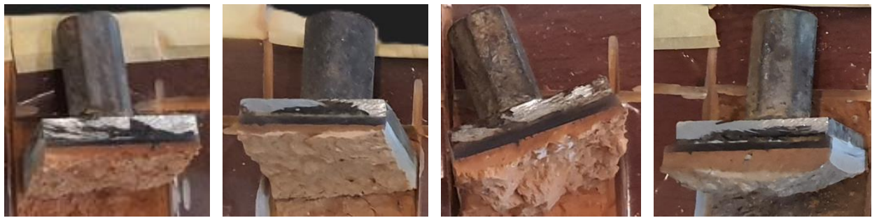
Рис. 3.14. Частина тіла цегли, що відірвалася при визначенні міцності зчеплення матеріалу з основою: а) Едмок; б) Едмок + Консолід 1 (1 шар); в) Едмок + Консолід 1 (3 шари); г) Едмок + Консолід 1 (5 шарів)
