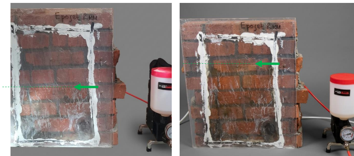
Рис. 3.22. Процес ін'єктування розчину Epojet (глибина умовної тріщини 2 мм)
