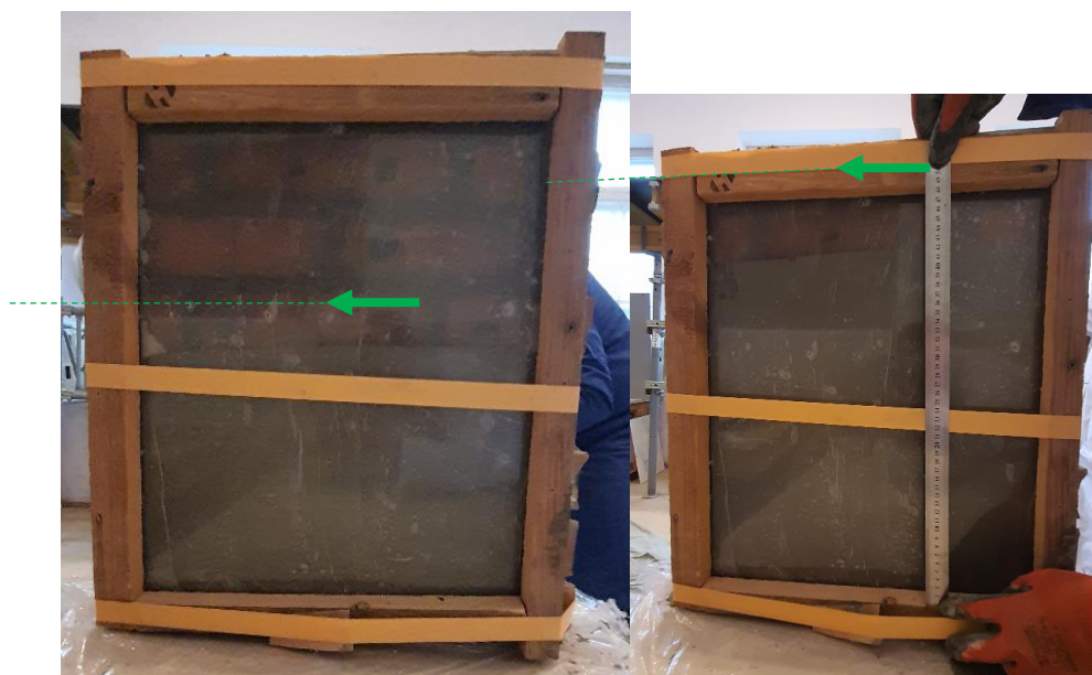
Рис. 3.23. Процес ін'єктування суміші Stabilcem (глибина умовної тріщини 4 мм)
